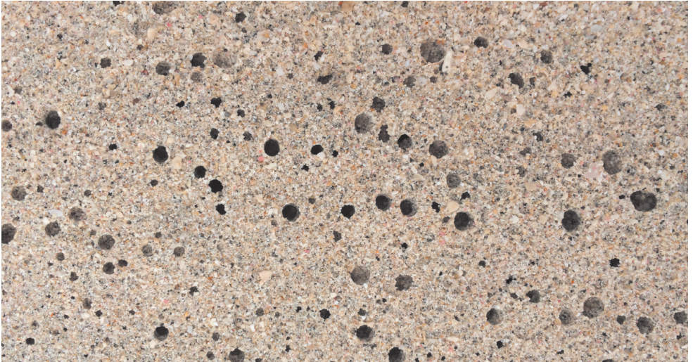
Afbeelding 6: Bij indringen van water in de poriën van onverzadigd zand zal er lucht moeten wijken, wat hier uit de gaatjes borrelde
