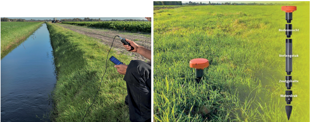
Afbeelding 3 Links: Mobiele EGV meter (AquaMobile), aangestuurd via Bluetoothverbinding met een app die de metingen direct (of later indien geen bereik) verzendt naar de cloud. Rechts: Modulaire Meetpin (Aqua Pin), welke naar wens kan worden opgebouwd met bodemvocht-, druk- en EGV-sensoren. De pin wordt direct in de bodem geplaatst en verstuurd gegevens telemetrisch (beide technieken worden geproduceerd door Fixeau B.V. en doorontwikkeld binnen het initiatief 'Boeren Meten Water').
