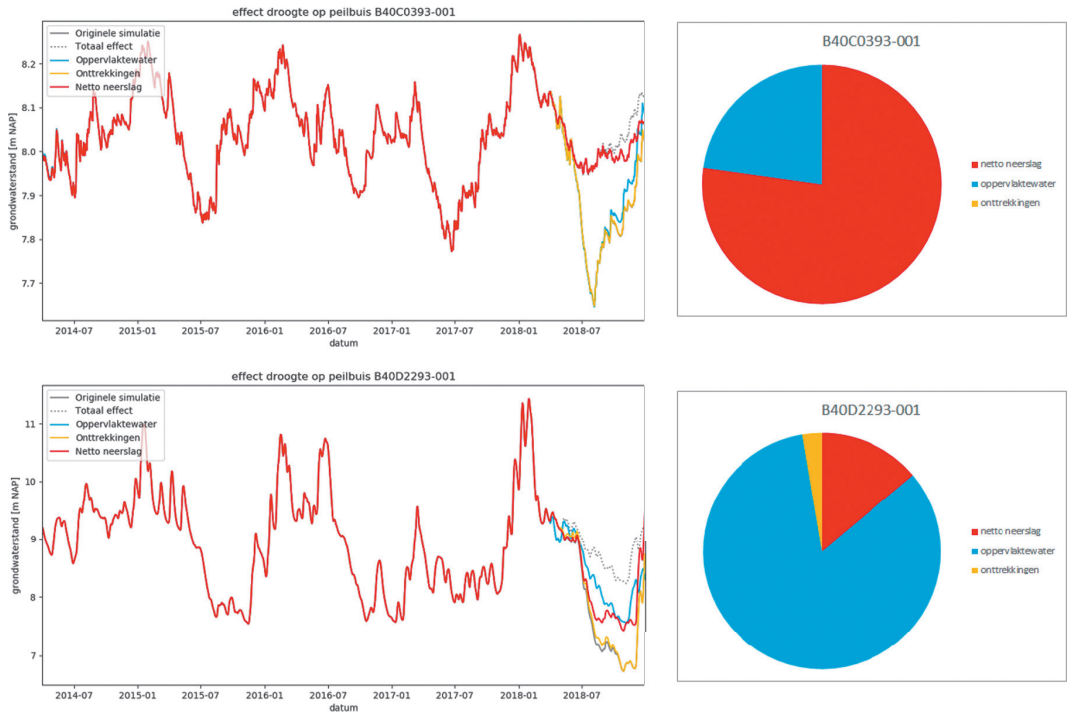
Afbeelding 7 Voorbeeld van de resultaten van de scenarioberekeningen voor twee peilbuizen, met hierbij de gesimuleerde grondwaterstand per scenario (links), en de relatieve bijdrage aan het aantal droge dagen in 2018, per invloed (rechts)
