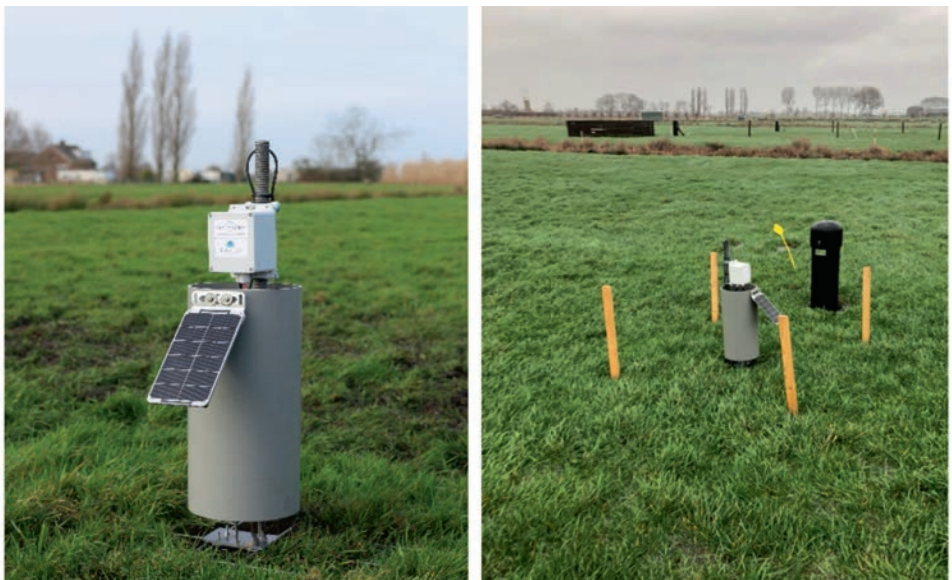
Afbeelding 6: Foto's van veldopstelling van VSM-sensor te Zegveld.
