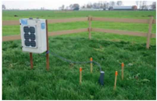
Afbeelding 8 Links: de bovenkant van een extensometer met een RVS plaat en de extensometerkop. Rechts: De meetsensoren van de extensometer, afgedekt met een kap, zijn met kabels bevestigd aan een datalogger met zonnepaneel.
