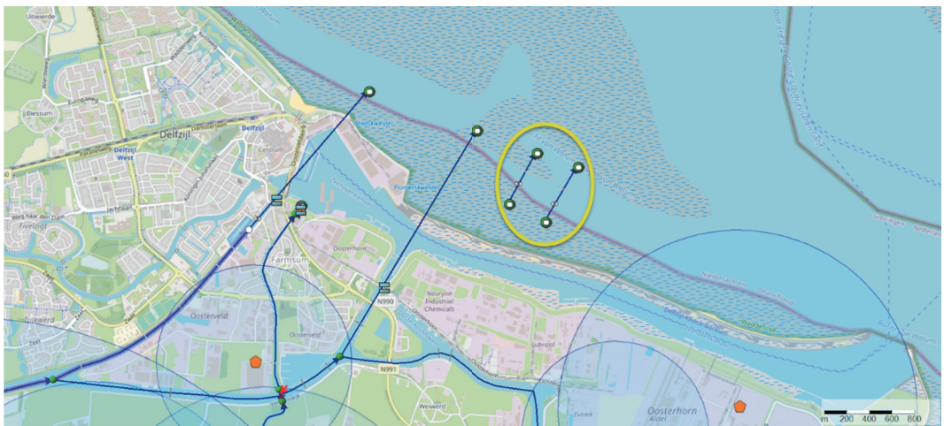
Afbeelding 7: Twee fictieve takjes (omcirkeld) met observation points in de modelschematisatie om het verwachte neerslagvolume en het verwachte aantal spui-stremmingen als input beschikbaar te krijgen in RTC.
